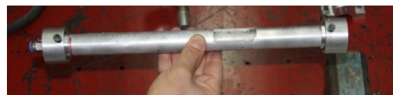
شکل ۶- تست ناشی لوله پرس شده به فلنج به روش هیدروفرمینگ
