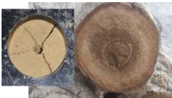
شکل ۵. نمایی از الوار چوب درخت خرما و تغییر در دانسیته چوب
