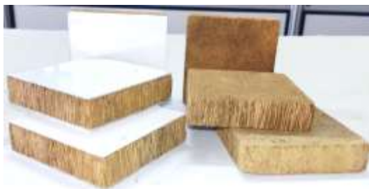
شکل ۱. نمایی از پانل ساندویچی و هسته چوب درخت خرما
