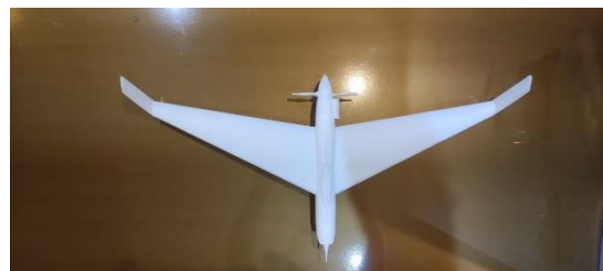
شکل ۱۸- مدل دلتا به همراه sweep از نمای بالا
