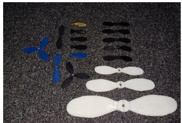
شکل ۴ - ملخ‌های ساخته شده با استفاده از پرینتر سه بعدی
