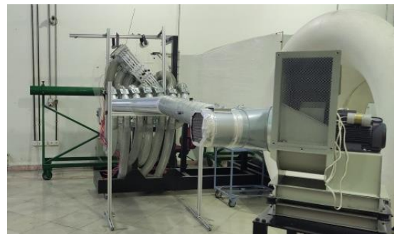
شکل ۲- نمایی از سکوی آزمون زنجیره خطی آزمایشگاه تحقیقاتی دانا ۳ به همراه سامانه مکش لایه‌مرزی
