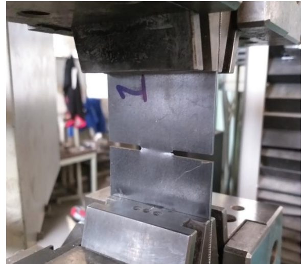
شکل ۸- نمونه تست کشش ورق ST44 با طول لیگامنت ۱۹ میلی‌متر
