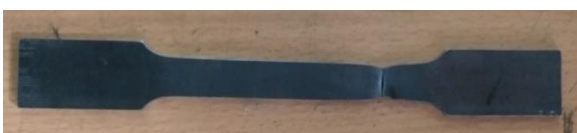
شکل ۴- شکست نمونه‌ی دمبلی بعد از تست کشش
