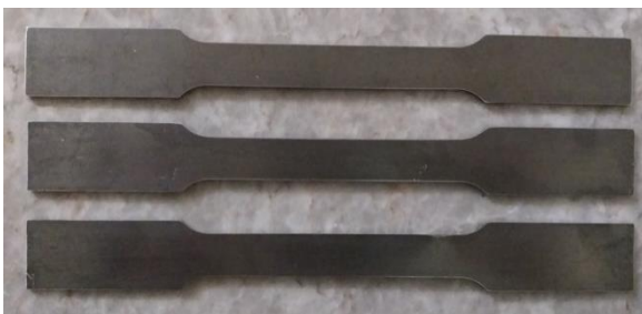
شکل ۳- نمونه تست کشش از ورق ST44
