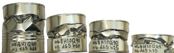
شکل ۵ - آزمایش لوله‌های جدار نازک سوراخ‌دار در ارتفاع یک متر
