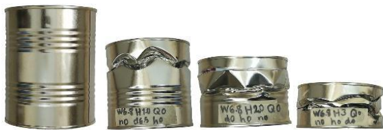
شکل ۴ - قوطی خام، پس از تست سقوط یک متر، دو متر و سه متر
