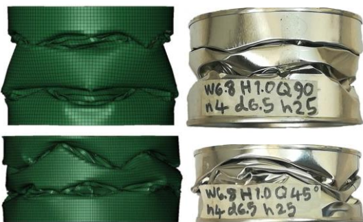
شکل ۹ - شبیه‌سازی پس از برخورد چکش به ارتفاع یک متر با اهداف سوراخ‌دار.
