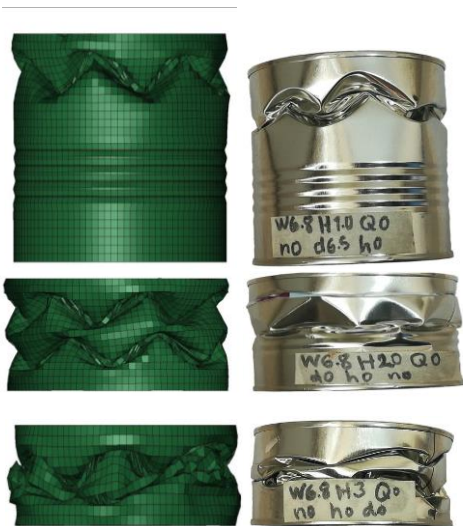
شکل ۸ - نمونه‌های شبیه‌سازی شده پس از برخورد چکش با ارتفاع (۱) یک و (۲) دو و (۳) سه متر
