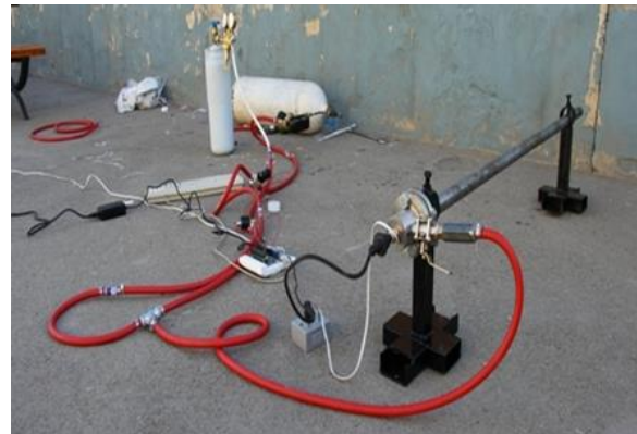
شکل ۵- مولد قدرت موج پالسی دتونیشن ساخته شده
