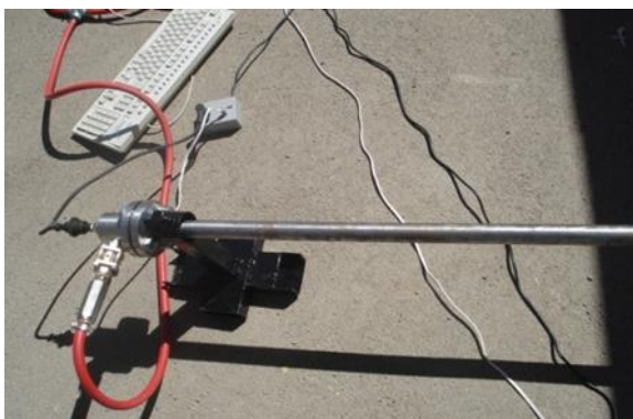
شکل ۷- مدار فرمان الکتریکی و سیستم جرقه محفظه مولد موج انفجار
