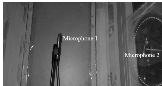
شکل ۳ - نمایی از میکروفون‌های نصب شده داخل اتاق آزمون به همراه مکانیزم انتقال دهنده
