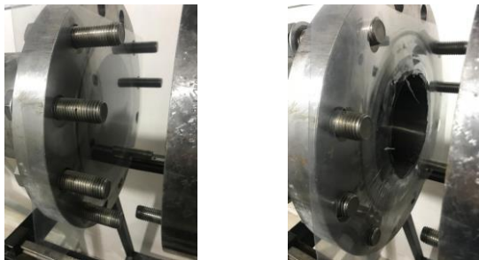
شکل ۹- دیافراگم ثانویه تونل شوک پیش و پس از انهدام دیافراگم
