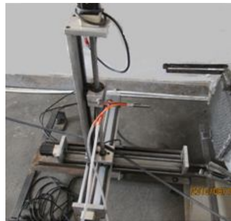
شکل ۳- چگونگی نصب لانه زنبوری به خروجی نازل و قرارگیری کاوشگر زاویه سنج جریان
