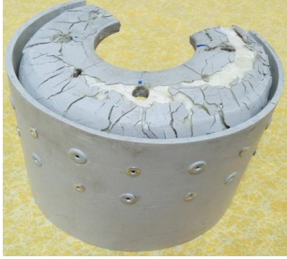
شکل ۲۳- پوسته کامپوزیتی شماره ۲ و اتصالات آن، کاملاً سالم مانده‌اند
