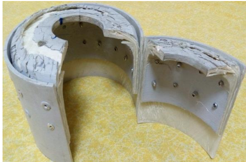
شکل ۱۸- ایجاد برش در مقطع پوسته و فلنچ شماره ۲
