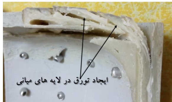
شکل ۲۱- تورق در لایه‌های میانی تیغه‌ی فلنچ شماره ۲
