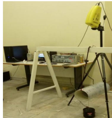
شکل ۷- چیدمان آزمایش مودال
