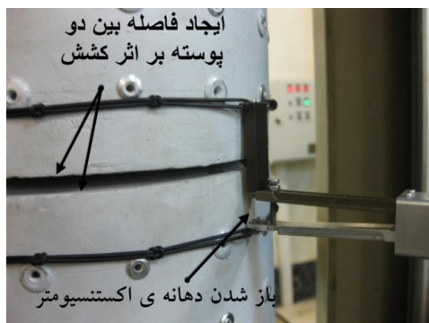
شکل ۱۲- جدا شدن لبه‌های دو پوسته بر اثر کشش
