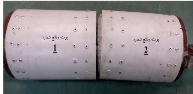
شکل ۱۶- سازه بعد از انجام تست کشش
