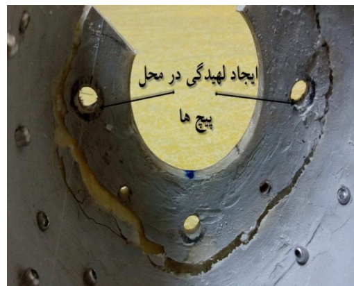
شکل ۲۲- ایجاد لهیدگی در محل پیچ‌ها
