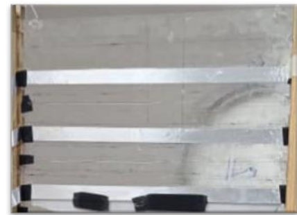
ب) فاصله بین عملگرهای پلازما دو و نیم سانتی‌متر
