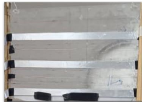
ب) صفحه تخت مورد استفاده با عملگرهای پلاسمای کرونای نصب شده
