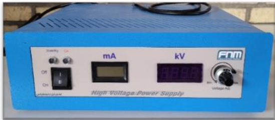
ب) منبع تغذیه ولتاژ بالا منفی شکل ۳- منابع تغذیه مورد استفاده.
