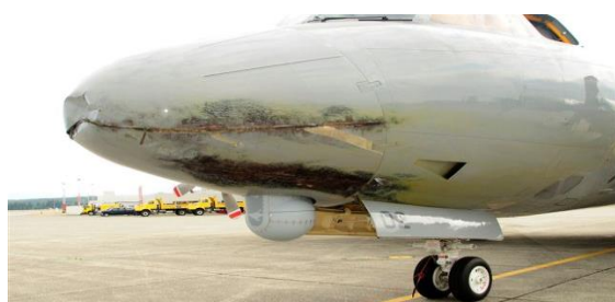
شکل ۲ - نمایی از آسیب سیستم اویونیک یک هواپیما
