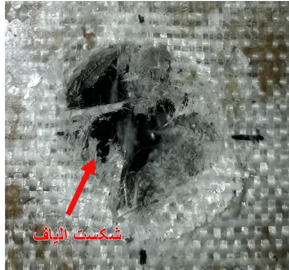
شکل ۱۱- ناحیه تخریب در سطح رویی و شکست الیاف
