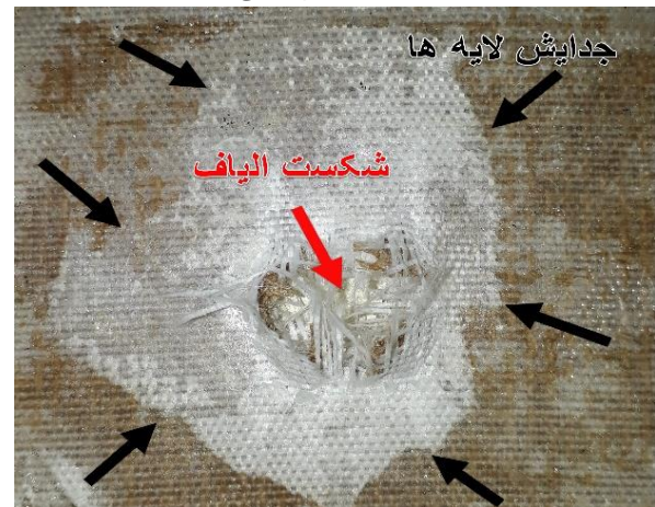
شکل ۱۲- سطح پشتی نمونه S5-9 و مشخص شدن نوع تخریب
