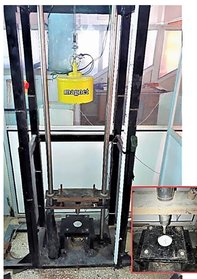
شکل ۲- دستگاه تست سقوط وزنه جهت آزمون ضربه نفوذی
