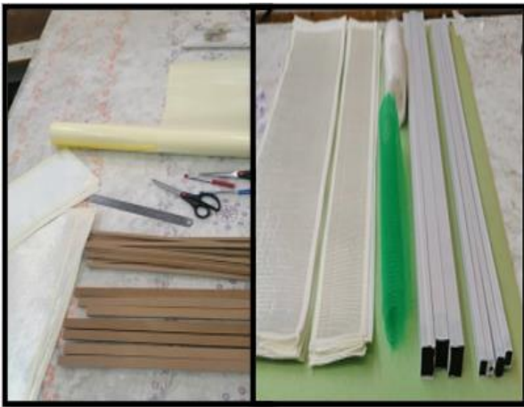
شکل ۱- شماتیکی از مواد مصرفی ساخت هسته مربعی
