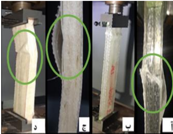
شکل ۱۰- نمایی از خرابی سازه ساندویچی با هسته مربعی تحت بار کمانش (الف- ب) بدون فوم (ج- د) با فوم
