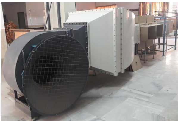
شکل ۱ - تونل باد اصلاح شده دانشگاه یزد
