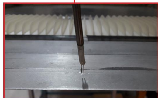
شکل ۵ - مدل صفحه تخت به همراه جریان سنج سیم داغ
