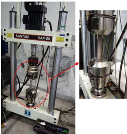
شکل ۵- دستگاه آزمون کشش به همراه نمونه
