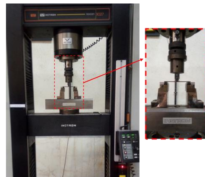
شکل ۸- دستگاه آزمون خمش سه نقطه به همراه نمونه تحت آزمون
