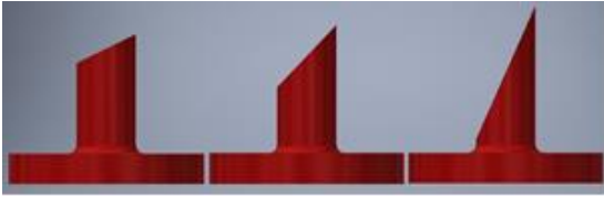
شکل ۳ - قسمت واگرای سه عدد نازل اریب به ترتیب از راست به چپ دارای زاویه‌های ۲۵، ۴۵، ۶۵ هستند.
