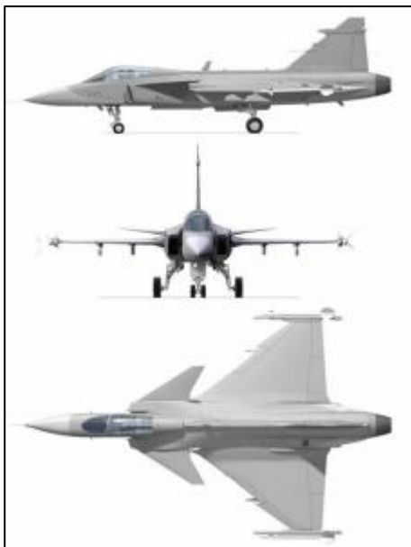
شکل ۱- هواپیمای ساب‌گرپین دارای پیکربندی کانارد و بال ۵
