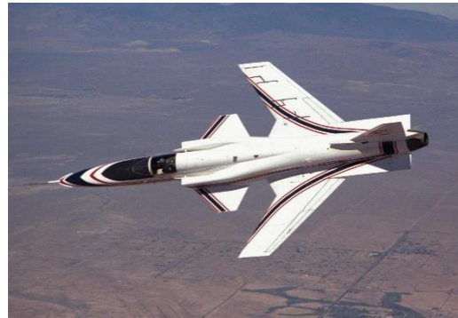
شکل ۲- هواپیمای X-29 دارای پیکربندی کانارد و بال [۶]
