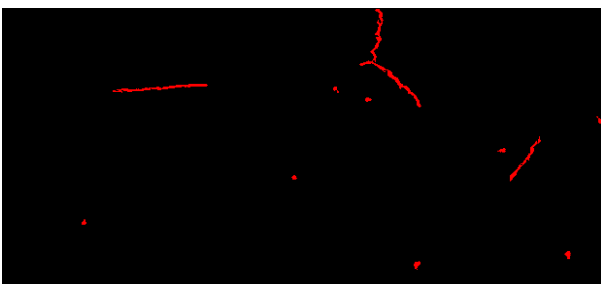
شکل ۱۲- خروجی الگوریتم تشخیص ترک با حساسیت کم
