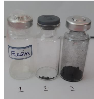
شکل ۱- نمایی از (۱) رزین اپوکسی (۲) گرافن اکساید عاملدار شده (۳) گرافن اکساید دندریمر
