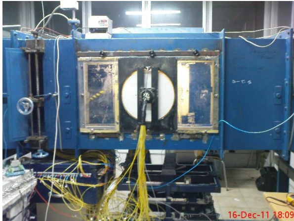
شکل ۱- محفظه تست تونل باد، تنظیم شده در نوسان پیچشی
