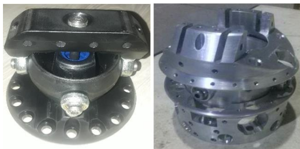
شکل ۱۵- تصویر دو نمونه اتصال گوی و کاسه‌ای ساخته شده جهت اتصال مجموعه پره‌ها با بدنه
