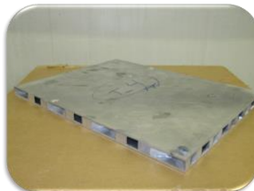
شکل ۹- نمونه شماره ۴ سازه ساندویچی با هسته مشبک- آلومینیومی و رویه‌های آلومینیومی
