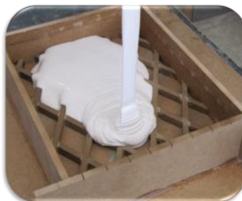
شکل ۲- ریخته‌گری سیلیکون در مدل چوبی
