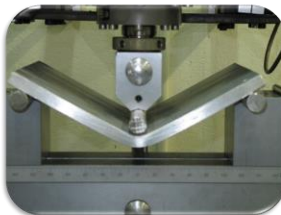
شکل ۲۴- نمونه شماره ۵ در لحظات آخر تست بارگذاری
