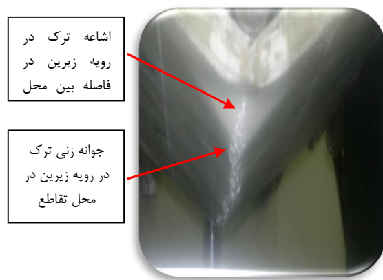
شکل ۱۶- جوانه زنی و اشاعه ترک در رویه زیرین نمونه شماره ۲
