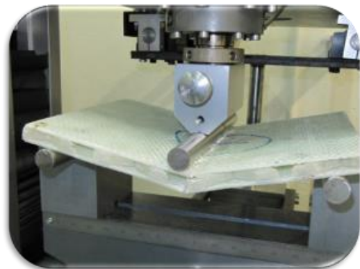
شکل ۱۶- شکست کامل نمونه شماره ۱ در لحظه پایان تست
