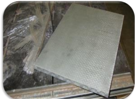
شکل ۵- نمونه شماره ۱ ساخته شده پس از برش زوائد اضافی
