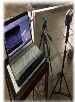
شکل ۷ - راه‌اندازی آزمون کشش همراه با تجهیزات همبستگی تصاویر دیجیتال
