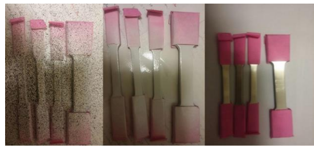
شکل ۶ - مراحل آماده‌سازی نمونه الف - نمونه پس از سنباده‌زنی ب - اسپره سفید ج - ایجاد الگوی تصادفی
