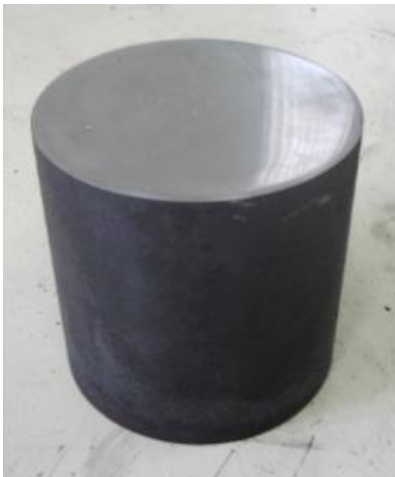
شکل ۳- سطح صیقلی نمونه آنیل شده برای اجرای آزمایش ناگ
