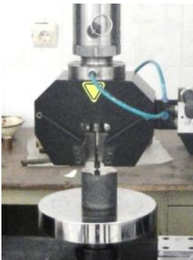
شکل ۴- نمونه ناگ زیر فک دستگاه STM-150
