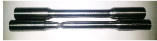
شکل ۵- نمونه کشش پیش و پس از آزمایش کشش
