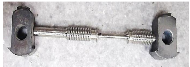
شکل ۲- تصویر نمونه آزمایش کشش طبق استاندارد ASTM-E8
