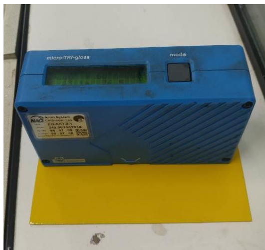
شکل ۱۰- تصویر انجام آزمون براقیت در ۶۰ درجه بر روی زیرآیندهای آلومینیومی و فولادی
