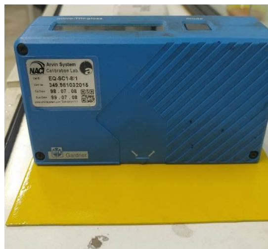
شکل ۵- تصویر دستگاه به منظور انجام آزمون براقیت در ۶۰ درجه
