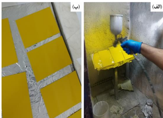
شکل ۳- الف) اعمال پوشش پلی‌یورتان توسط پیس توله ایرلس،
