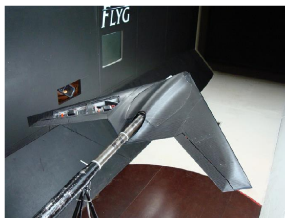
شکل ۳ - مدل آزمون در تونل باد سرعت پایین [۲۶]
