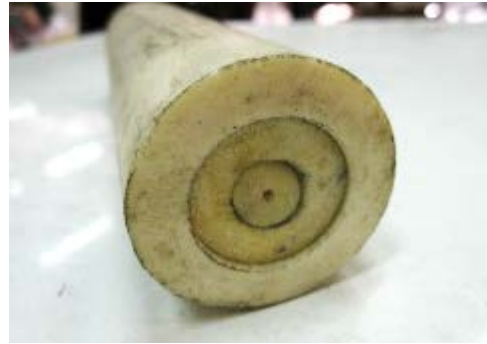
شکل 5 - لایه‌های فوم تابعی شعاعی به صورت تلسکوپی
