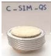
شکل 10 - نمونه استوانه‌ای پر شده با فوم ساده بعد از آزمایش فشار و نمودار L-D آن
