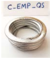
شکل 9 - نمونه استوانه‌ای خالی بعد از آزمایش فشار و نمودار L-D آن
