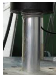
شکل 8 - نمونه استوانه‌ای تحت بارگذاری فشاری شبه‌استاتیکی
