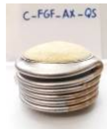
شکل 11 - نمونه استوانه‌ای پر شده با فوم تابعی محوری بعد از آزمایش فشار و نمودار L-D آن
