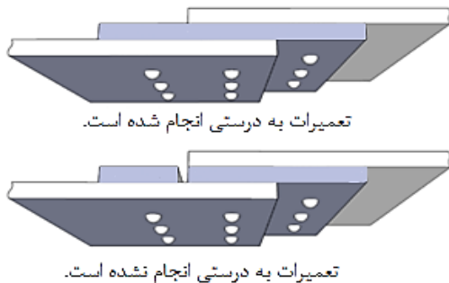
شکل ۵ - تعمیرات صحیح و اشتباه در پرچ کاری
