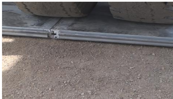
شکل ۱۳- اعمال نیرو توسط تایر کامیون در مرز بین دو صفحه
