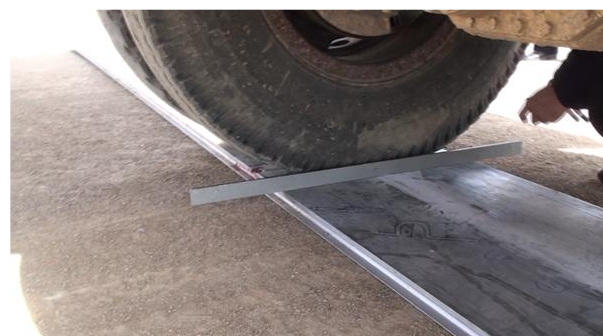
شکل ۱۴- نمونه‌ای از اندازه‌گیری تغییر شکل صفحه با استفاده از خط‌کش تراز
