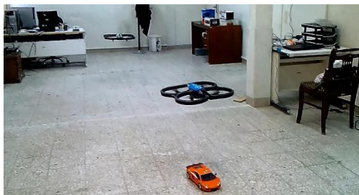
شکل ۱۵ - نمایی از سناریوی جستجو و ردیابی اهداف متحرک زمینی در محوطه آزمایشگاه توسط دو چهارپره
