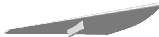
شکل ۴- تصویر سه بعدی بال در حل اعتبارسنجی (به مقیاس نیست)
