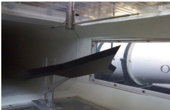
شکل ۴- مدل مورد آزمایش نصب شده در مقطع آزمایش به همراه تجهیزات اندازه‌گیری
