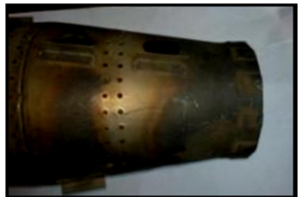
شکل 18- سوختگی در انتهای محفظه احتراق
