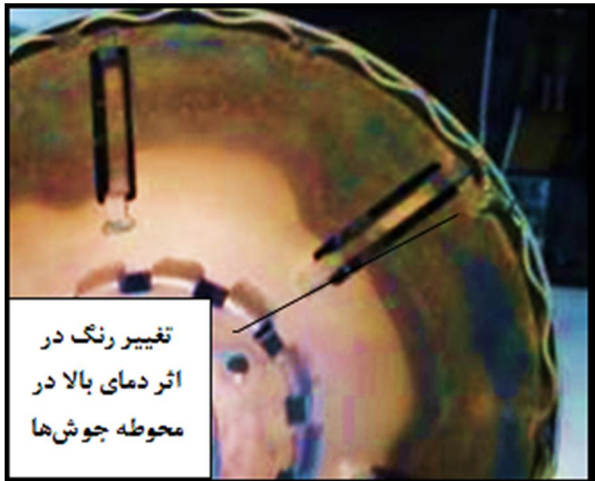
شکل 15- علائم دمای بالا در اطراف جوشکاری‌های محفظه احتراق
