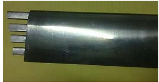
شکل ۸- حالت پنجم بال به همراه ۴ بالک از بزرگ به کوچک.
