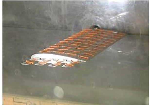
شکل ۱۱- الگوی جریان برای حالت ۲ در زاویه حمله ۰ درجه.
