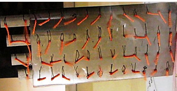
شکل ۲۴- الگوی جریان بر روی بال برای حالت ۵ در زاویه حمله ۲۰ درجه.
