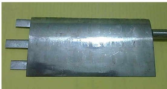
شکل ۷- حالت چهارم بال به همراه بالک ۳ سانتی‌متری در وسط و ۲ طرف ۲/۵ سانتی‌متری.
