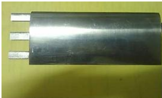
شکل ۶- حالت سوم بال به همراه ۳ بالک ۲/۵ سانتی‌متری.
