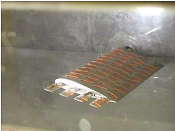
شکل ۱۶- الگوی جریان بر روی بال برای حالت ۲ در زاویه حمله ۱۳ درجه.
