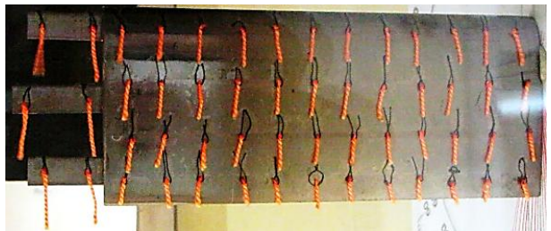
شکل ۱۳- الگوی جریان بر روی بال برای حالت ۴ در زاویه حمله ۰ درجه.
