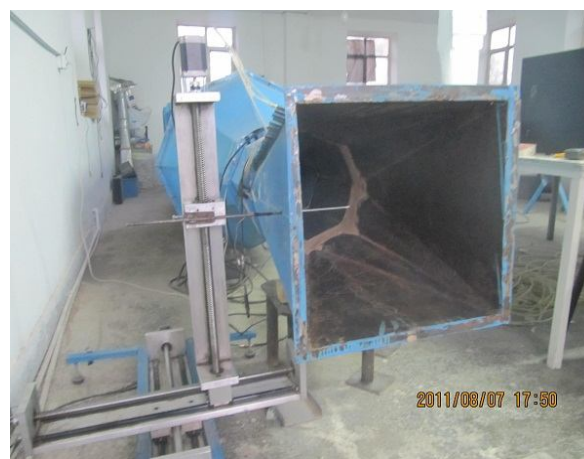
شکل ۳- مکانیزم انتقال دهنده مورد استفاده برای اندازه گیری توزیع سرعت
