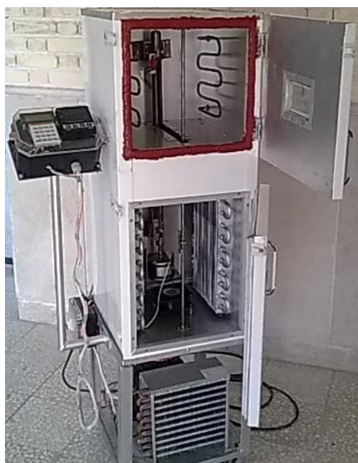
شکل ۳ - نمای کلی از دستگاه بارگذاری حرارتی سیکلی
