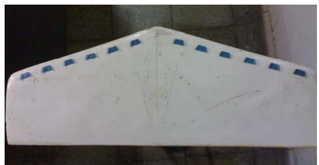
شکل ۵- نمائی از مدل آزمایشگاهی با تولید کننده گردابه با زاویه سمتی ۱۵ درجه
