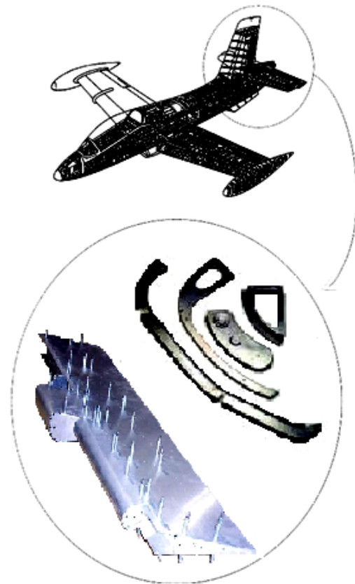
شکل ۱ - نمونه‌هایی از قطعات هواپیما که با روش شکل‌دهی فلزات ورقه‌ای ساخته می‌شوند [۲]
