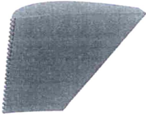
شکل ۱۳- Baffle مدل سازی شده پره شامل سوراخ‌های خنک‌کاری بر خوردی
