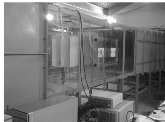
شکل ۴- نحوه قرار گرفتن مدل در داخل اتاق آزمون و اتصال آن به دستگاه مبدل فشار
