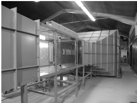
شکل ۳- نمایی از تونل باد استفاده شده در این تحقیق
